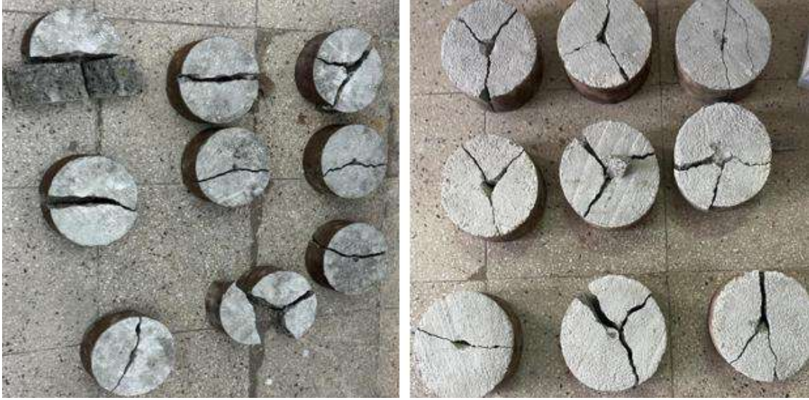
Şekil 7. Darbe numunelerinin kırılma şekilleri
