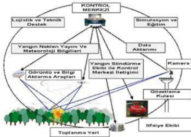
Şekil 2. Yangın kulesinin çalışma biçimi (Kılıç, 2010).
