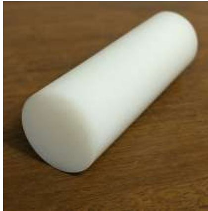
Şekil 1. Deneylerde kullanılan POM-C malzeme örneği
