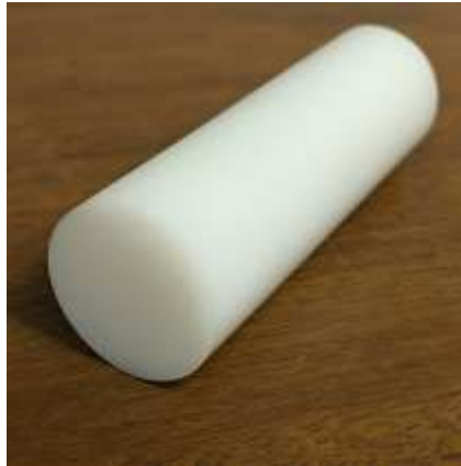
Şekil 1. Deneylerde kullanılan POM-C malzeme örneği
