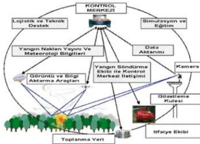
Şekil 2. Yangın kulesinin çalışma biçimi (Kılıç, 2010).
