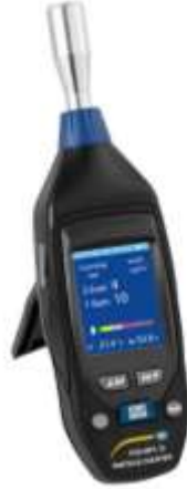
Şekil 2. PCE-MPC 10 partikül ölçer
