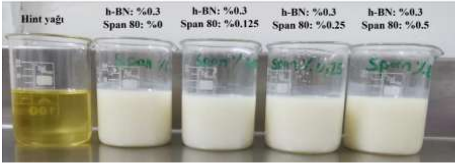
Şekil 3. Farklı yüzey aktif madde oranlarıyla üretilen bor nitrür nanopartikülleri katkılı Hint yağlayıcılar
