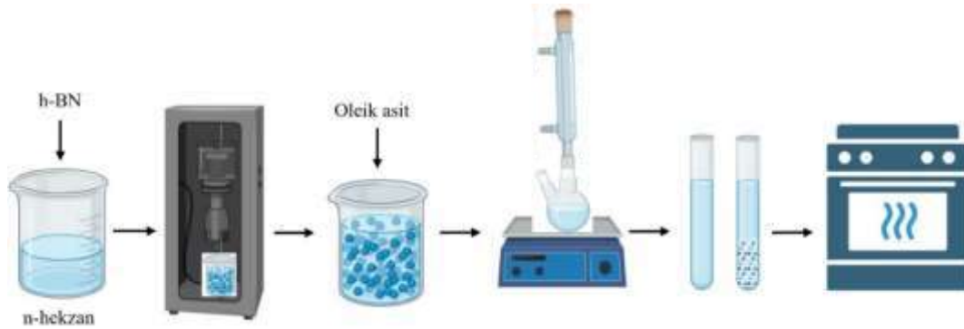
Şekil 2. h-BN nanopartikülünün oleik asitle modifikasyon işleminin adımları
