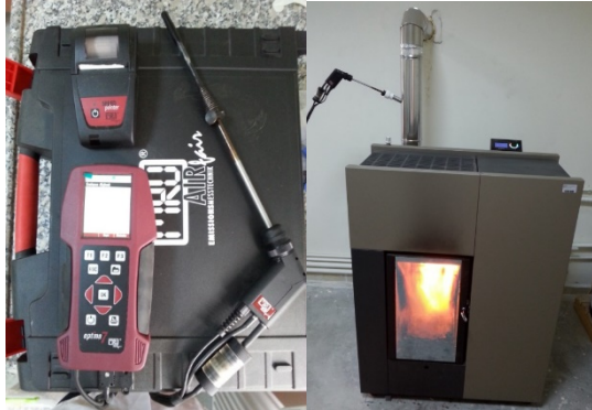
Şekil 5. Baca gazı emisyonu ölçüm cihazı ve yanma gazları analizinde kullanılan pelet sobası
