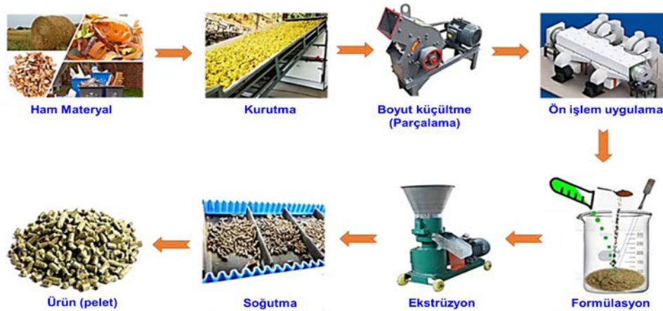
Şekil 3. Biyopelet üretiminin şematik gösterimi (Sarker et al., 2023).
