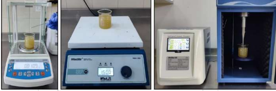
Şekil 4. Kaolin nanopartikülleri katkılı bitkisel esaslı palm yağlayıcıların hazırlanması işlemi; a) Tartım, b) Manyetik karıştırıcıda karıştırma, c) Ultrasonik homojenizatörde karıştırma
